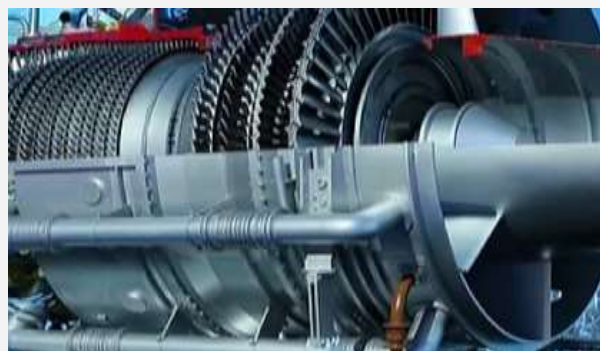
ГТУ 110 МВт в рамках проекта строительства ТЭС
