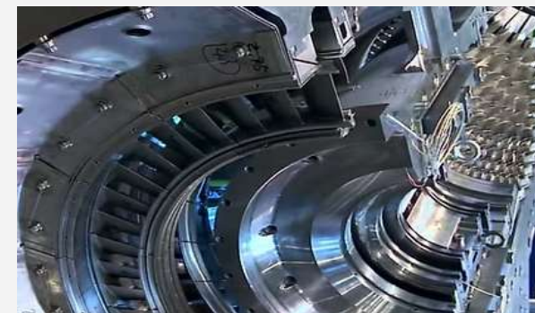
Компоненты газовой турбины MS5002E мощностью 32 МВт
